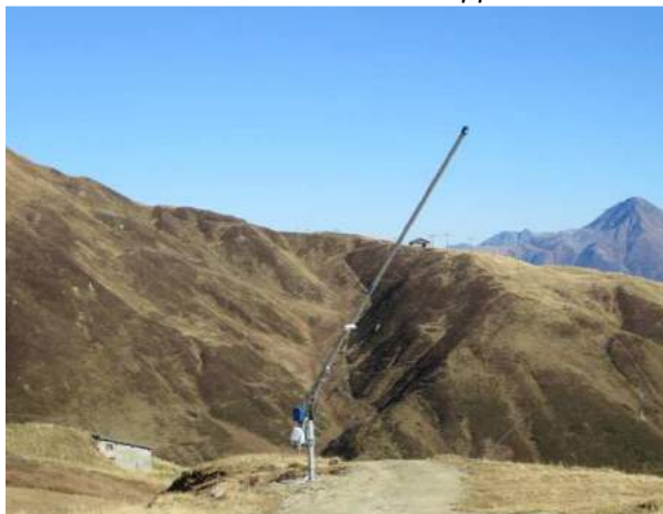
Nadel für die Erzeugung von Kunstschnee auf der Piste vom Piz Calmot ins Val Val
